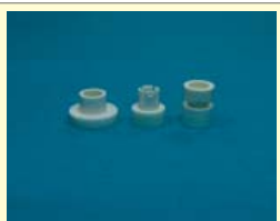
Материал: нейлон-66 Класс огнестойкости: 94V-2 Отверстие в плате: 7,5 мм Отверстие в шасси: 4,5 мм Цвет: натуральный
