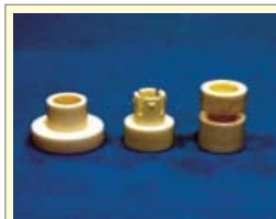
Материал: нейлон-66 Класс огнестойкости: 94V-2 Отверстие в плате: 6,5 мм Отверстие в шасси: 4,0 мм Цвет: натуральный
